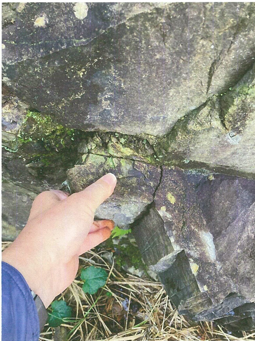
【資料5】 人の力でも簡単に崩れる脆い岩（左） すでに土砂崩れが発生している（上）
